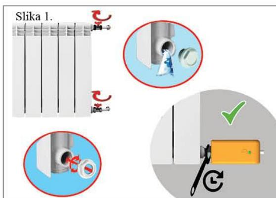
postupak se radi samo jednom jer se u slučaju eventualnog kvara grejača ili elektronskog regulatora temperature isti samo izvuku iz kućišta koje ostaje trajno u grejnom telu. Kada se proveri ima li curenja i ako ga nema onda postaviti telo regulatora u takav položaj koji najviše odgovara korisniku da može imati lak pristup dugmetu za zadavanje željene temperature i videti indikatorsku sijalicu (slika 2.).
